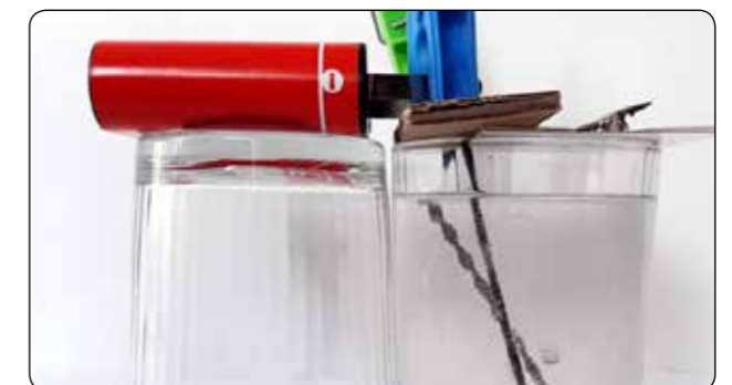
Obrázek 10: domácí aparatura na elektrolýzu NaCl
