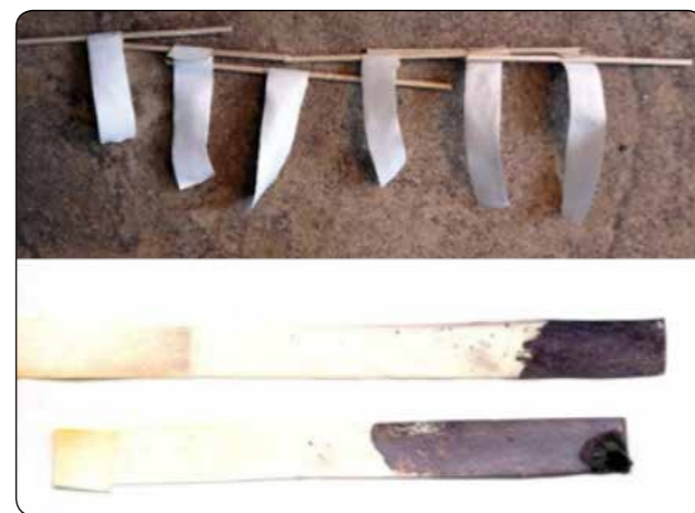
Obrázek 12: výroba jodidoškrobových papírků a důkaz chlóru
